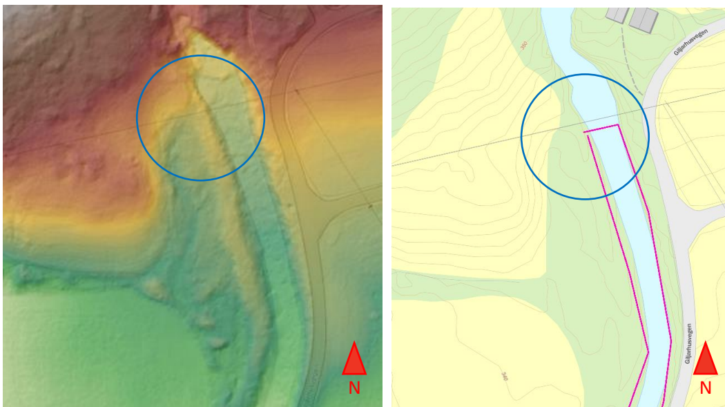
Figur 2.32 Høydekart og markert område der Giljarhuselv flommet over sine bredder og til dels ødela plastringen (t.v., Høydedata) og kart med omtrent plassering av sikring fra NVE vist i rosa (t.h., NVE Temakart)
