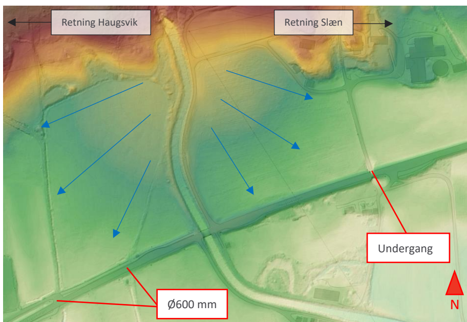
Figur 2.28 Avrenning dersom Giljarhuselv flommer over plastringen (Høydedata)
