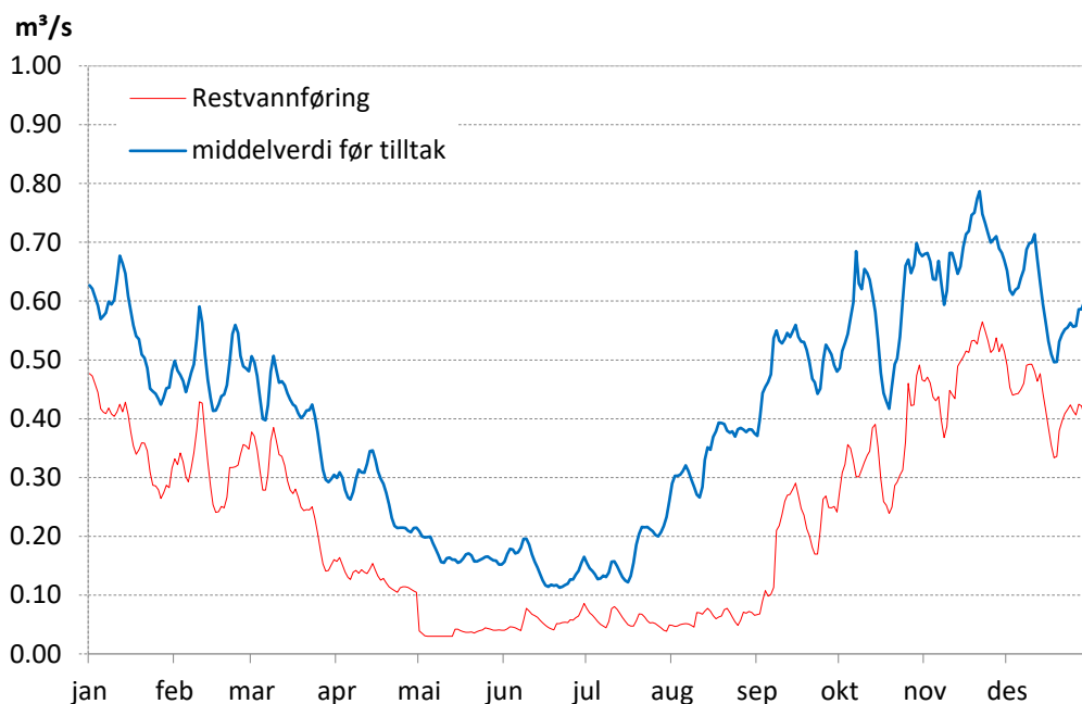
Figur 15 Plott som viser gjennomsnittlig døgnvannføring for perioden 2006-2020 før (blå) og etter søkt uttak (rød) med slipp av minstevannføring på 30 l/s i perioden 01.05-30.09 og 100 l/s i perioden 01.10-30.04 ved utløpet av Håvikvatnet. Simuleringene er basert på observasjonsserien fra 2006 til og med 2020 fra referansestasjon 39.2 Kallandsvatnet.
