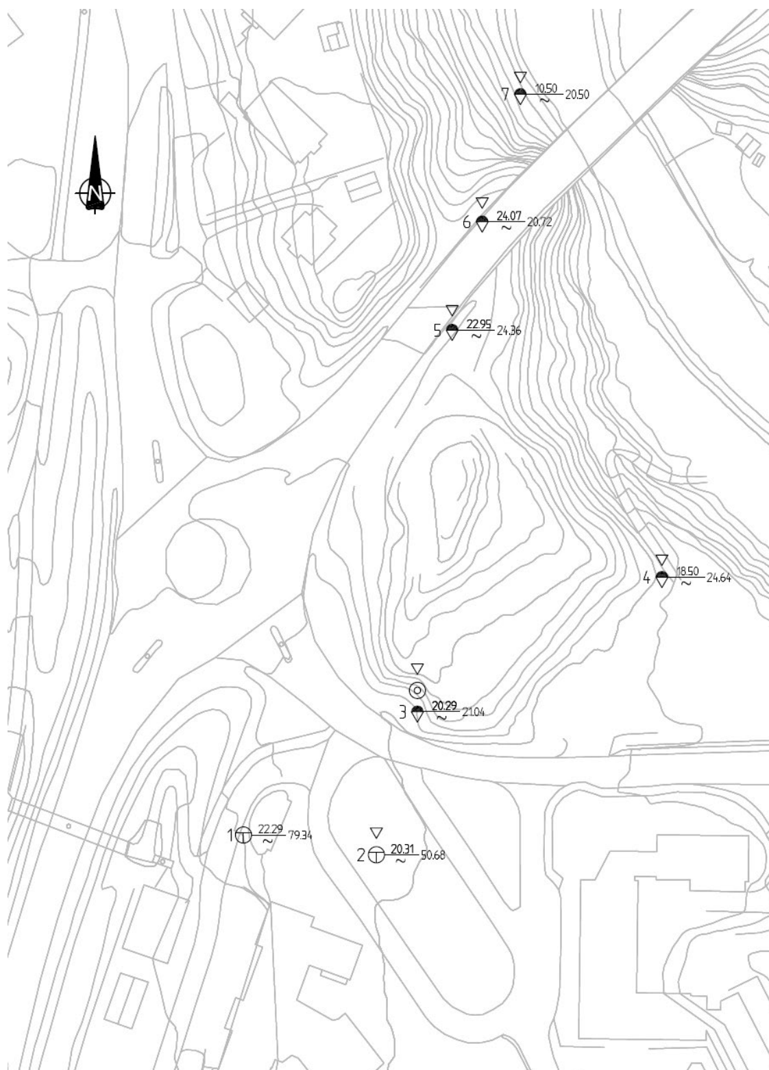
Figur 3: Utsnitt fra borplan og grunnundersøkelser gjennomført av NGI i 2009.
