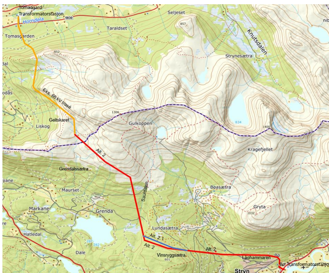
Figur 2-15: Linja omsøker ett trasealternativ i oransje trasé, ett i rød (alt. 2) trasé og ett i blå (alt. 2.1) trasé.
