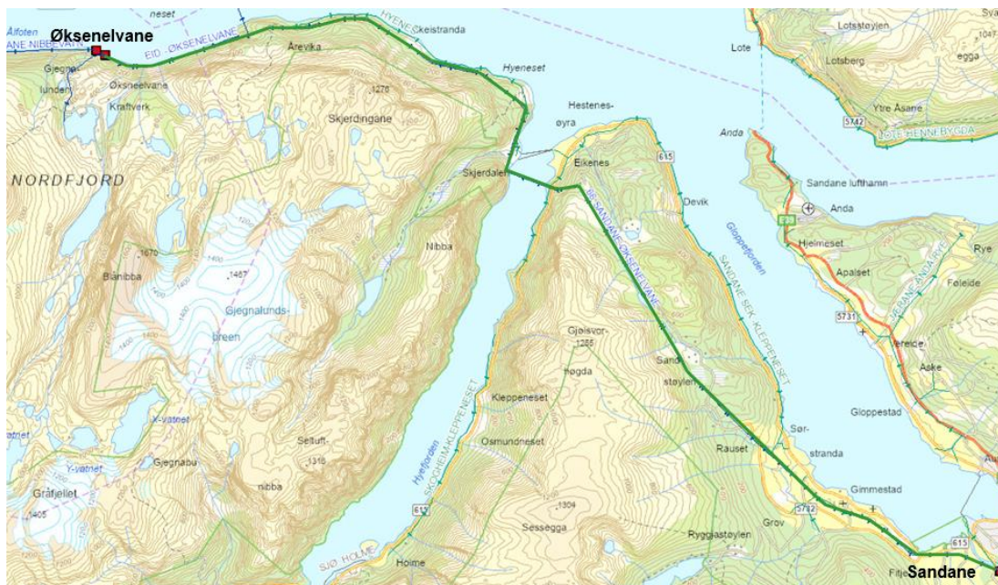
Figur 2-14: 66 kV ledningen mellom Sandane og Øksnelvane (grønn linje), som Linja ønsker å sanere.
