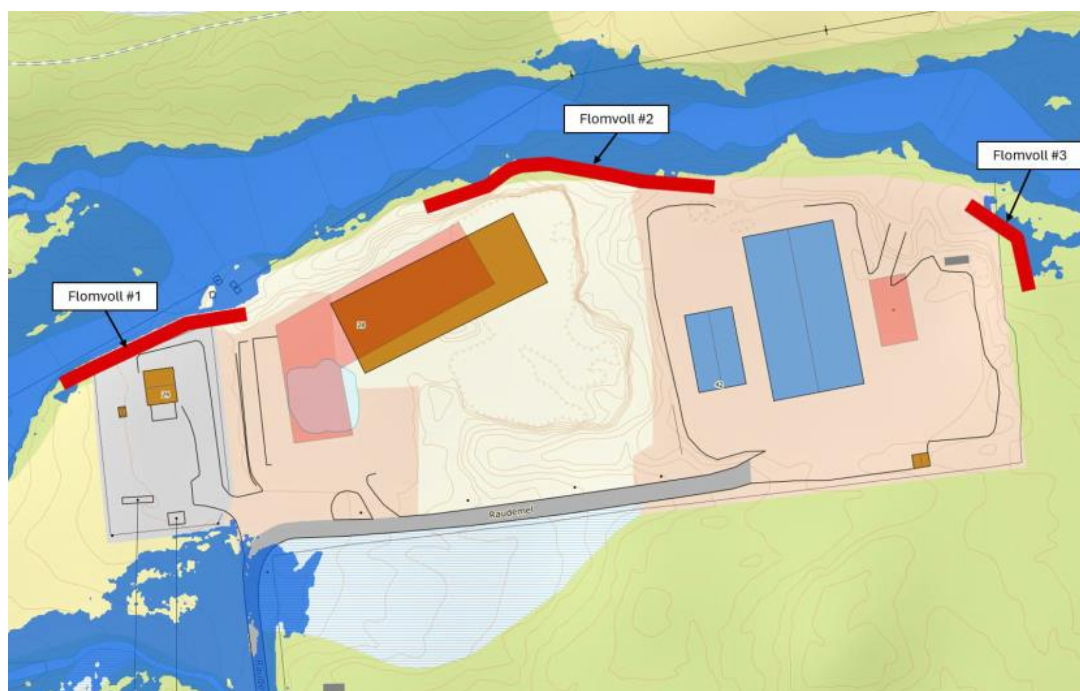
Figur 6-3: Flomutbredelse fra Horndøla og bekk sør for tomt (grå), 200-årsflom inkl. 20% klimapåslag og 50% sikkerhetspåslag. Terreng justert med ca. +1m ved flomvoller (rød).
