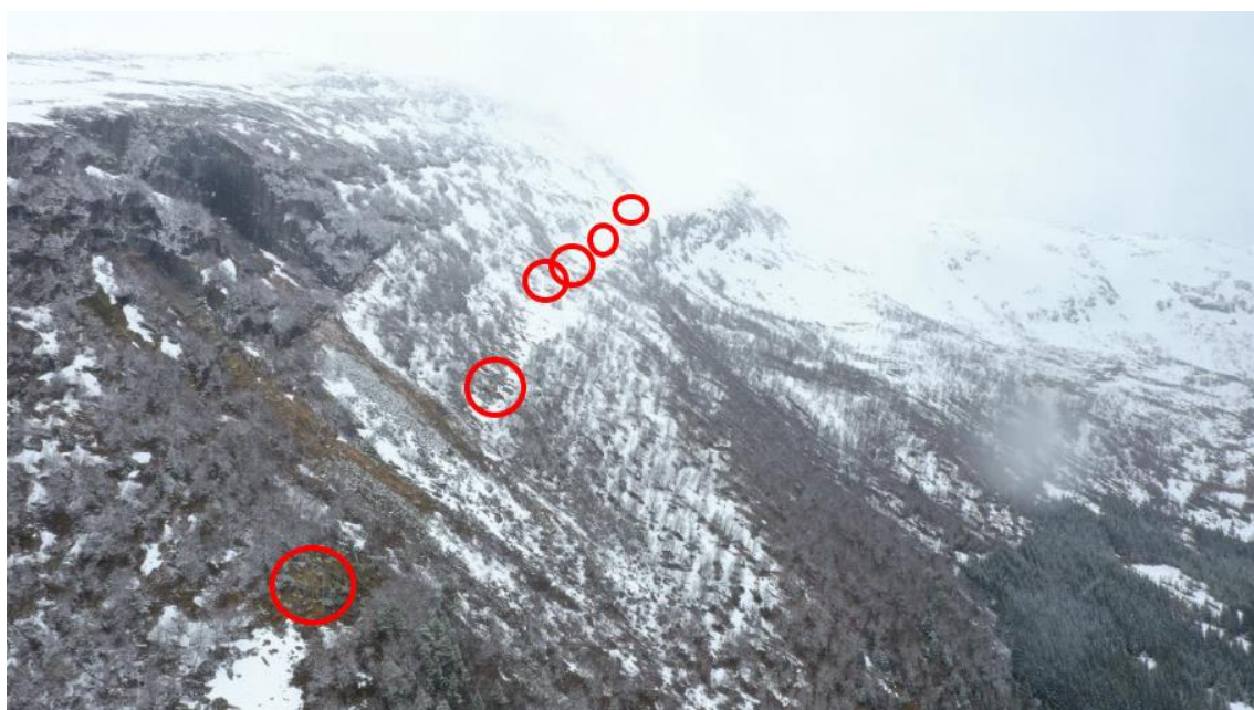
Figur 6-4: Mast 51–56, med M56 nærmest i bildet. Det er tydelige skredspor mellom M55 og 56.
