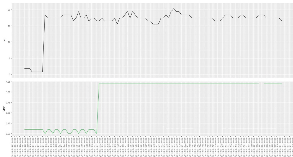
Figur 7 4,5 døgn mai 2018. Last økning til ca. max last uten at det er stor vannstandsending. Mulige årsaker til liten påvirkning på vannstand er enten overløp på inntaksdam eller mulig høyt lokal tilsig?
