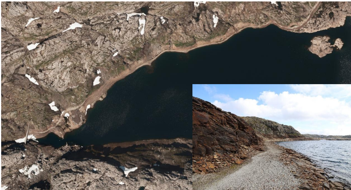
Figur 23. Ortofoto fra 21.07.2013 viser eksisterende adkomstvei i Gilavatnet som skal heves ved bruk av tunnellmasser og få nytt toppdekke i grove masser. Innfelt bilde viser veien i august 2025.
