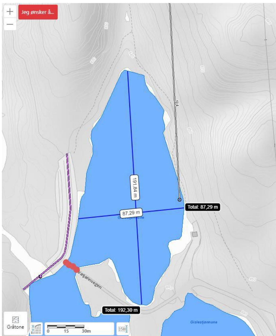
Figur 2 Detaljbilde over Skartjønn delen av inntaksmagasinet. Største bredde: 87 meter og største lengde 192 meter. Røde sirkler marker stedet for bjelkestengsel.
