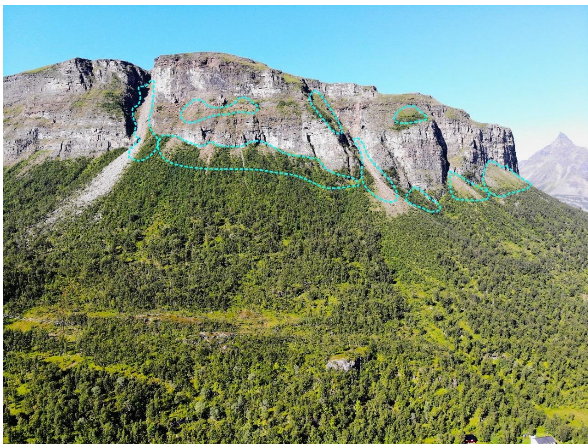
Figur 69: Deler av løsneområder for snøskred tegnet inn i dronebilde i delområde E. Foto: Arktisk Geotek AS.
