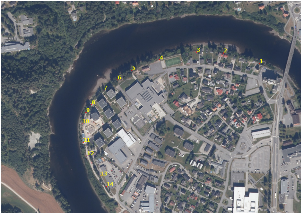
Figur 5: Langs med Storelva er det målt 14 tverrprofiler for kartlegging av erosjon (NVE, 2023). Nummerering indikerer startpunkt for profilene.
