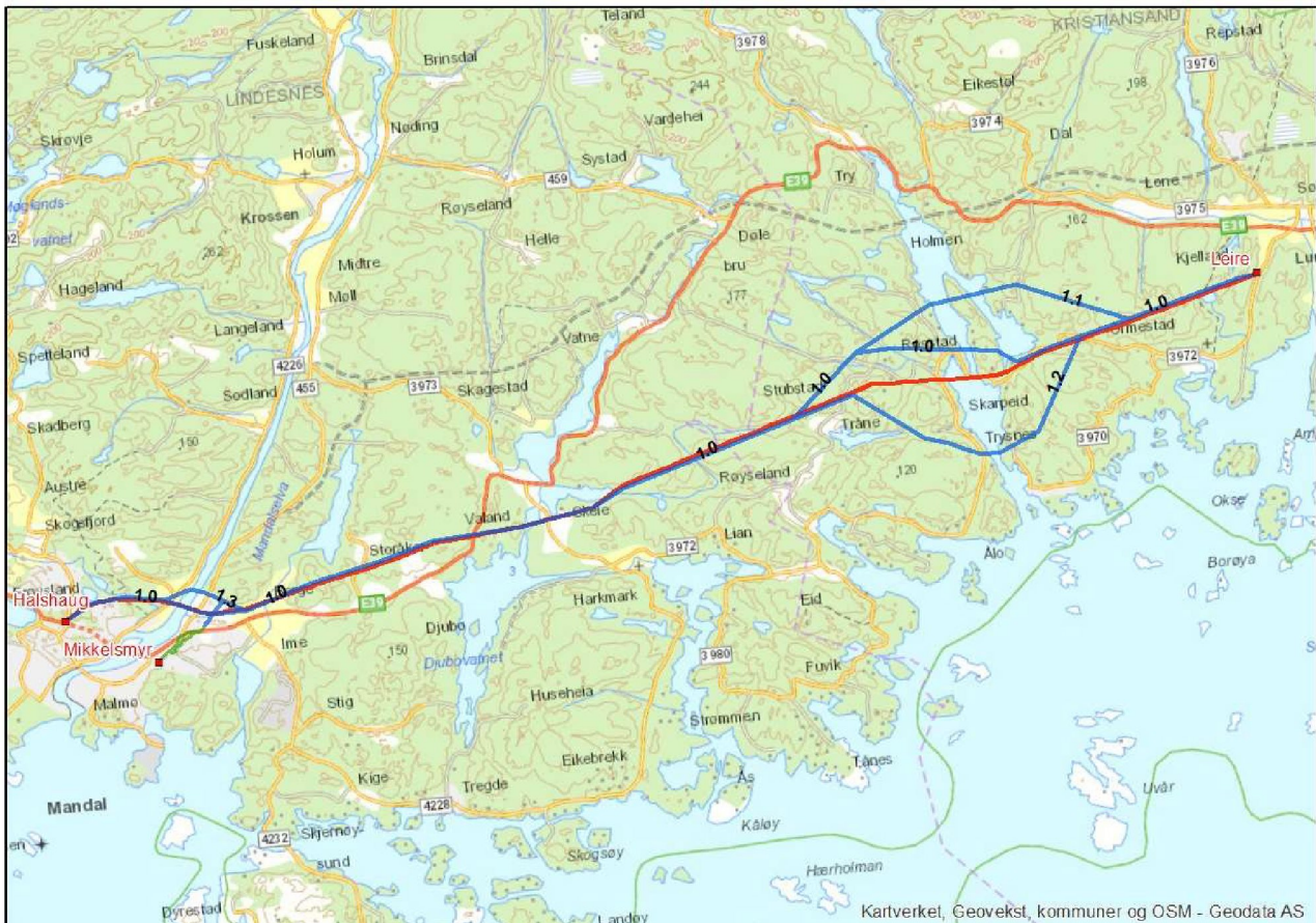
Figur 5-2. Meldte traseer på strekningen Leire – Halshaug. Blå luftledning og grønn kabel. Eksisterende ledning som rives er vist med rødt.
