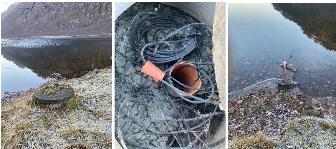
Figur 7. Plassering av elektronisk utstyr som viser sanntidsdata for vannstand i Første Fiskfjordvatn (til venstre i kartet). Fastmerke (øyebolte i stein) er festet i en stor stein (til høyre i kartet) (3d.kommunekart.com).
