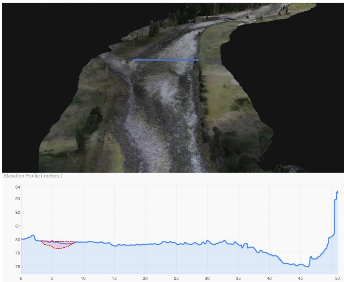
Figur 40. Eksempel på sentrering av elveløp (illustrert med rødt i profil) for å samle lavvannføring til en konsentrert del av elvetverrsnittet ("elv i elva") der elva har flat og bred elvebunn som medfører at vannet nærmest blir «borte» mellom steinene på de lavere vannføringene.
