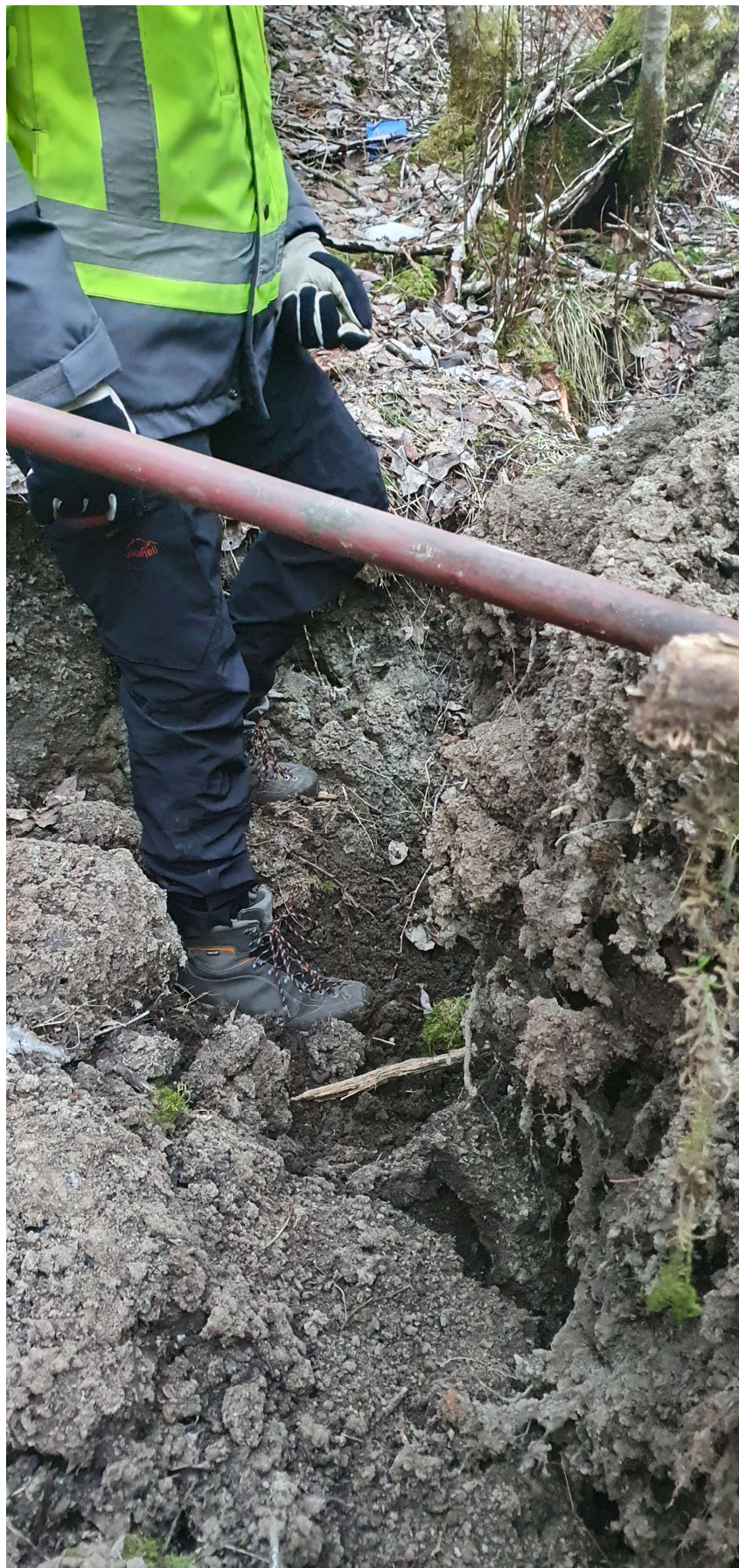
Figur 5: Under rota på et veltet tre ble det funnet sandige masser. 10-20 cm under det synlige laget med sandige masser ble mer leirige/siltige masser gravd frem.
