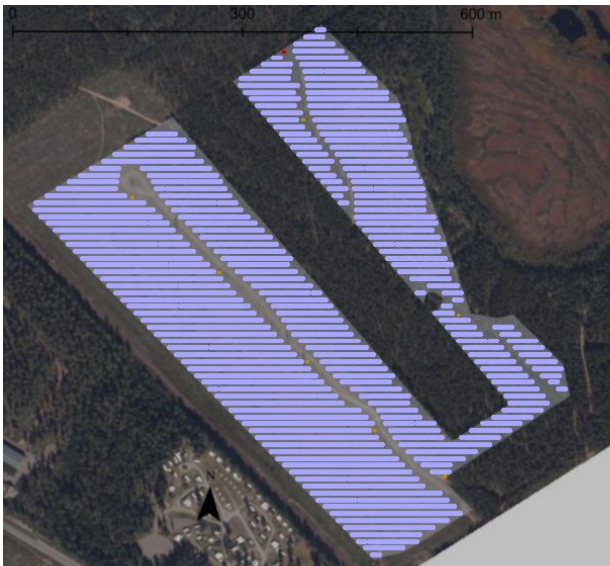
Figur 2-2: Grov skisse av solcelleanlegget med plassering av solcellepanelrader (blå rektangler), interne transformatorstasjoner med vekselretter og transformator (oransje rektangler), og hovedadkomstveier innad i anlegget der det er opphold i panelrader langs eksisterende vei/traktorvei. Hovedpunkt for tilknytning er foreløpig satt på den nordlige delen markert i rødt.
