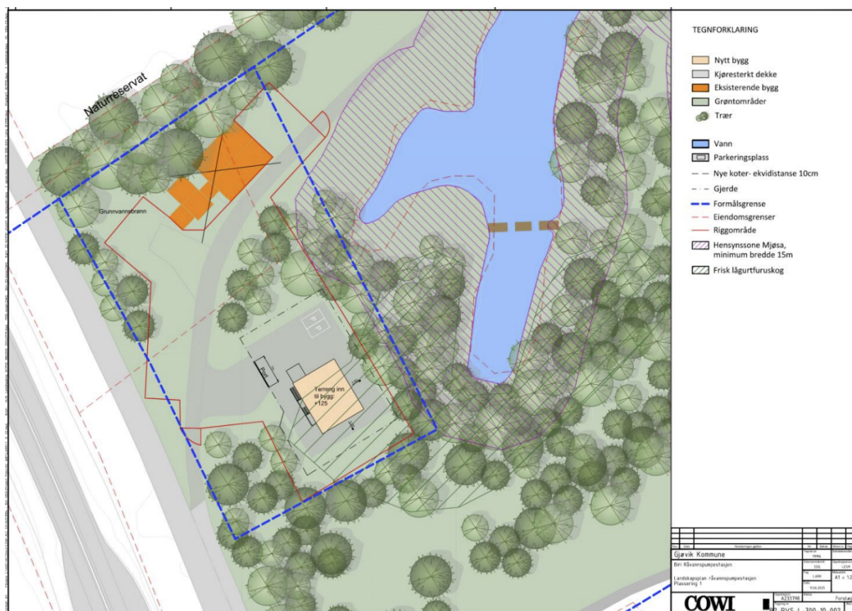
Figur 22 Utklipp fra foreløpig landskapsplan som viser områder der råvannspumpestasjonen (RVS) skal etableres. RVS er markert som beige. Stiplet blå linje viser regulert område for RVS, heltrukken rød linje viser
