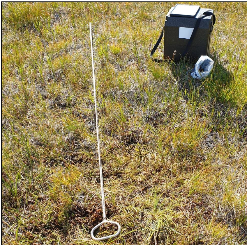
Figur 3-21. Bilde av prøvetakingsutstyret: Russerstangen (midt i bildet) brukes til å måle dybder og å ta ut jordprøver med. Jordprøvene ble lagt i en rilsanpose og deretter i en svart isoporboks fra Eurofins (øverst til høyre). Prøvepunktet blir koordinatfestet og prøvedata blir notert ved hjelp av en iPad. Foto: Magnar Bjerga, Multiconsult.
