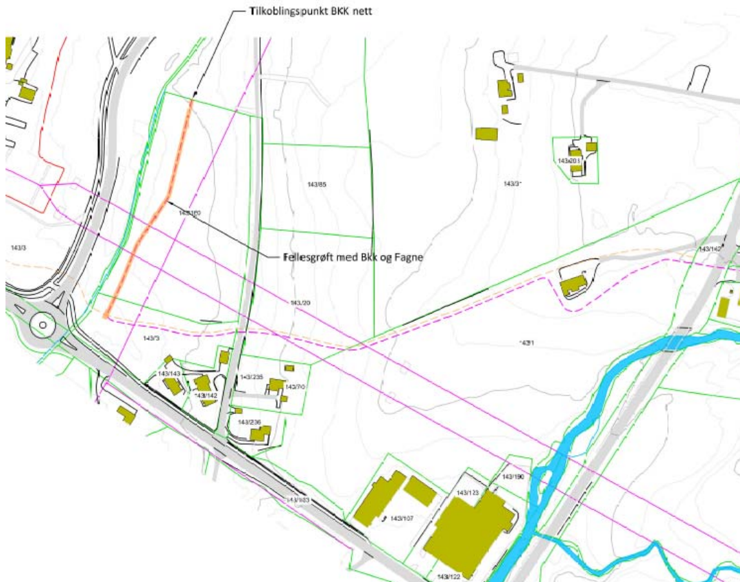
Kart 2B. Situasjonsplanen som syner kabeltrasè frå kryssing av FV 500 til påkoplingspunktet mot BKK (lilla stiplet linja og fellesgjøft med BKK/Fagne gitt med orange farge)
