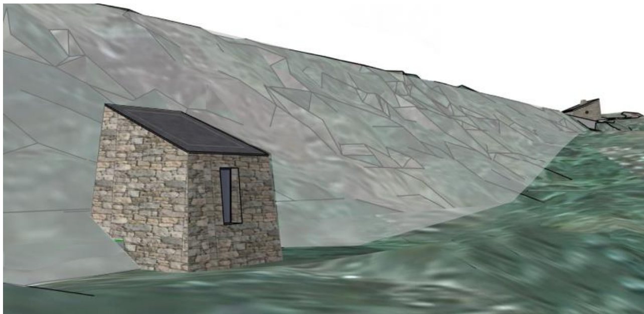
Figur 3-7. Skisse av nytt lekkasjemålehus.
