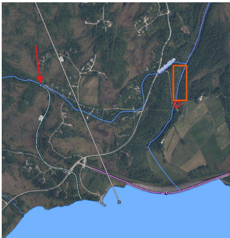
Figur 3 Rød pil viser hvor vi vil slippe deler av tilsiget fra Svartbekken. Rød ring viser tunnelutløpet. Det oransje rektangelet er elvestrekningen som ikke vil få annen vannføring en restfeltet.
