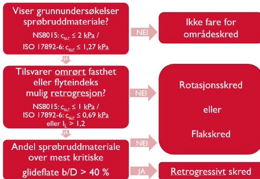
Figur 4.15: Figur 4.3 fra NVE-veilederen, /1/, flytskjema for vurdering av skredmekanisme
