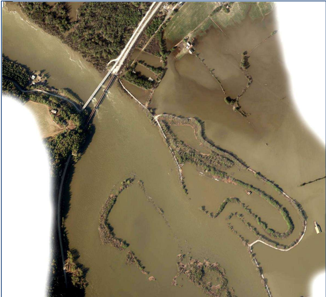
Figur 6. Flom ved Randklev 2. mai 2018 kl. 10:00. Vannføring målt til å være 2244 m³/s. Foto: Kartverket.
