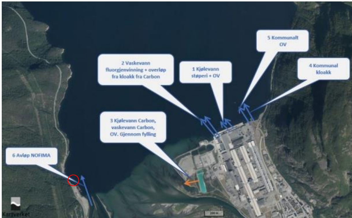
Figur 4.7: Punktutslipp fra Sunndalsfjorden til Sunndalsøra [33]. Rød sirkel viser planlagt nytt utløpsområde for Aura kraftverk.
