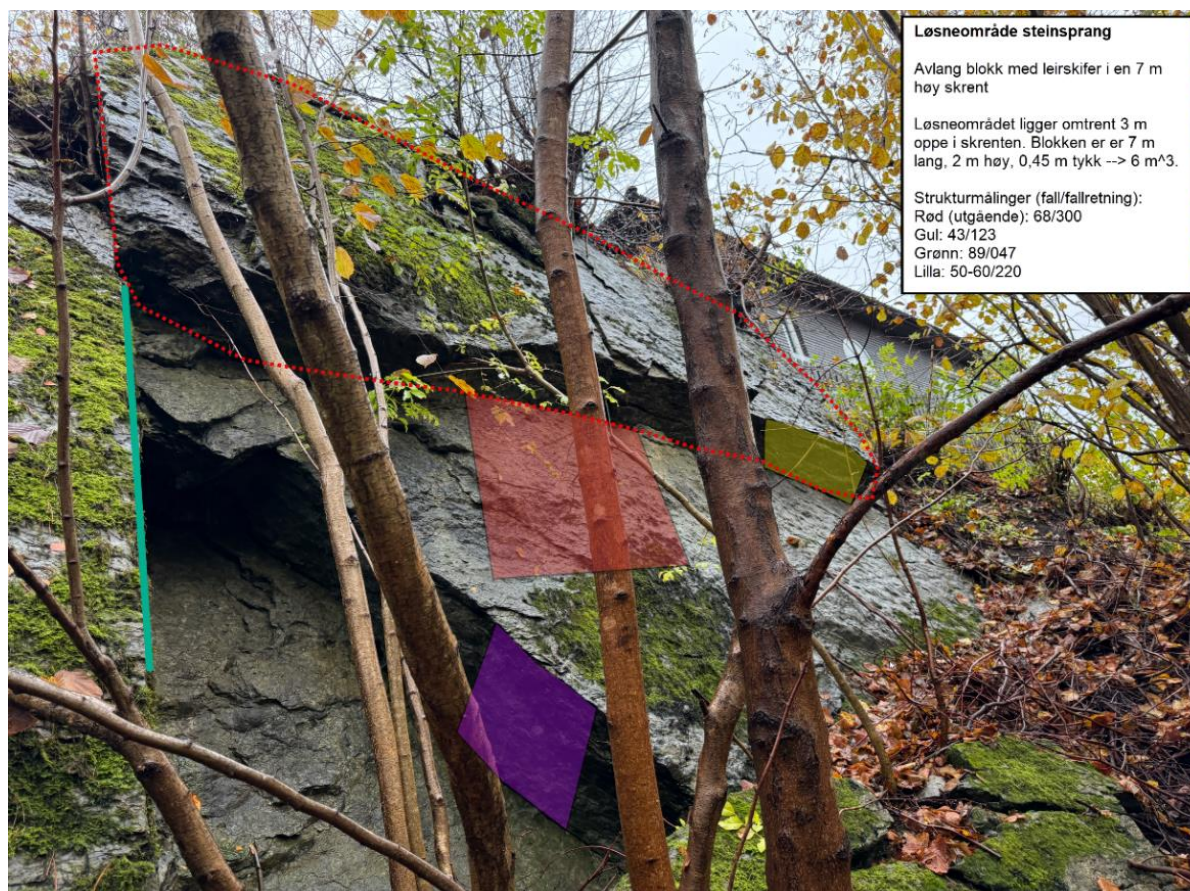
Figur 5-1: Løsneområde for steinsprang med markerte plan for sprekkemålingene.
