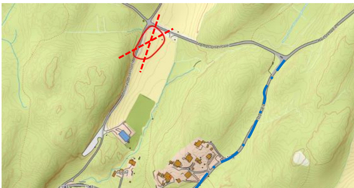
Figur 8: I området markert i rødt på hjørnet av et jorde kan teoretisk utgjøre et løснеområde. På befaring viste det seg at det var berg i dagen mellom jorde og veien som gjør at faren for skred kan utelukkes. Langs blå stiplet linje langs Hvitstenveien er det hyppige bergblotninger ifølge google streetview som tilsier at det er bergmassiver på begge sider av veien. Boligområdet er befart i detalj og det er hyppige bergblotninger i området, viser til vedlegg.
