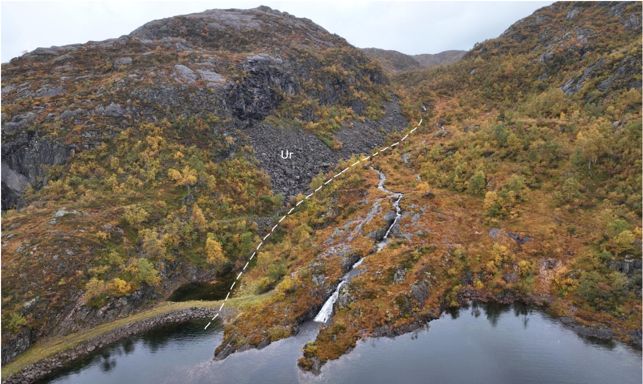
Figur 5-17 Dronefoto over Suldal 2B sitt område for inntak og plassering av lukehus. Et mindre søkk i terrenget er markert med hvit stiplet linje.
