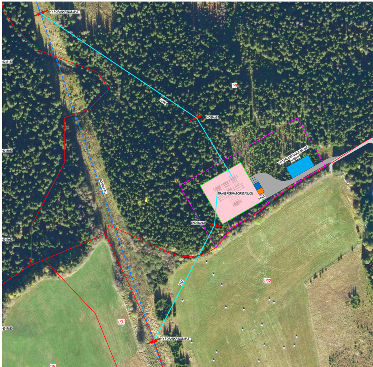
Figur 5. Skisse over alternativ 1 for nettilknytning. Det etableres en kort omlegging av dagens 132 kV overføringslinje Dokka- Fall, som går rett vest for Seval skog (kilde: Energeia AS).
