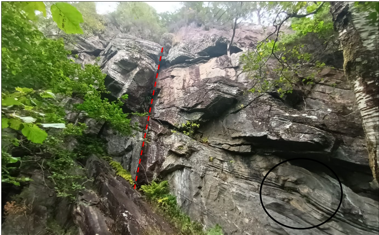
Figur 7: Foliasjonsplana i den søraustlege delen av hammaren har eit fall mot søraust på kring 40^\circ , og det er danna fleire overheng mot sørvest i hammaren. Hovudsprekkeplanet føl hovudsakleg foliasjonsplana, men det er òg sprekkplan som føl lineasjonane i regionen, orientert nordvest-søraust, som går normalt på foliasjonsplana (markert med raud linje). Det er i tillegg lokal faldedanning i fjellet (svart omriss), med sprekkdanning langs faldane. Infopunkt 6.
