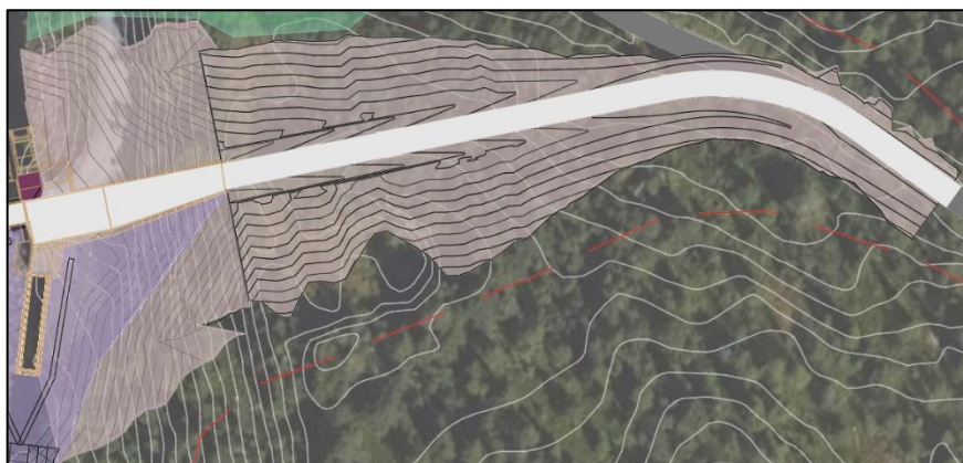
Figur 3-2: Avgraving av terreng og ny vei øst for dammen. Hentet fra arealbruksplan.
