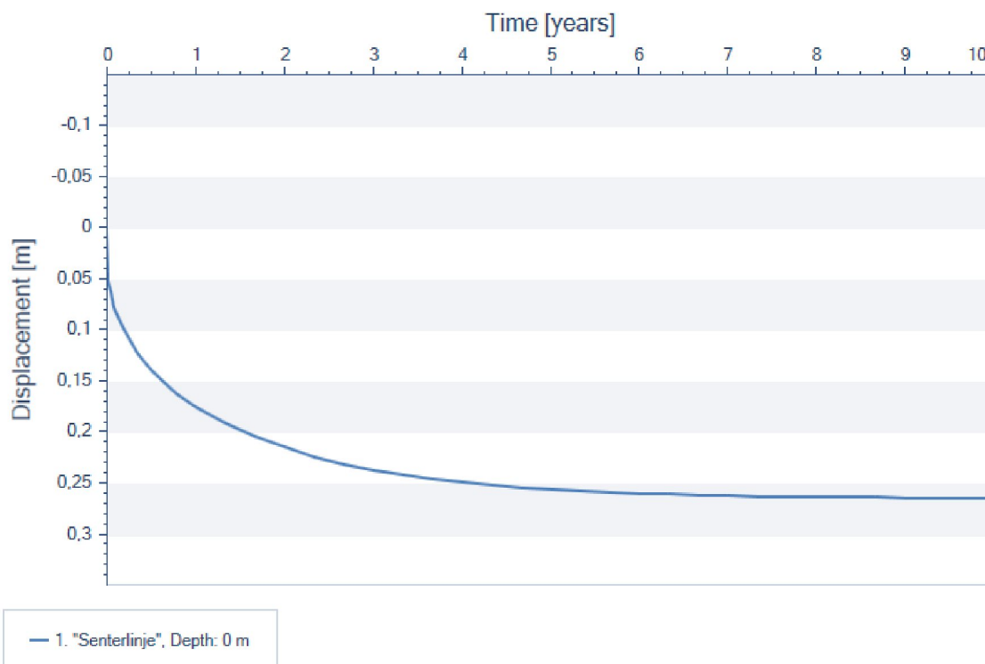
Figur 2: Setning/tid-diagram for motfylling i profil 8290
