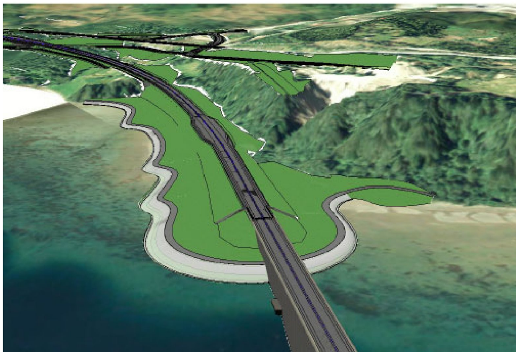
Figur 2: Planlagt fylling/motfylling (SVV - B11172-GEOT-01)
