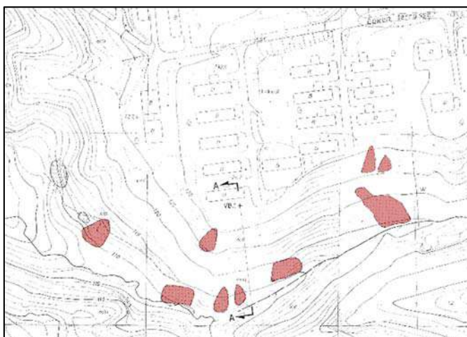
Figur 3-3: Kartlagte overflateras i Sundevjas sydøstre arms dalskråning mot Løken terrasse i nord, vist i rødt, ref. /7/
