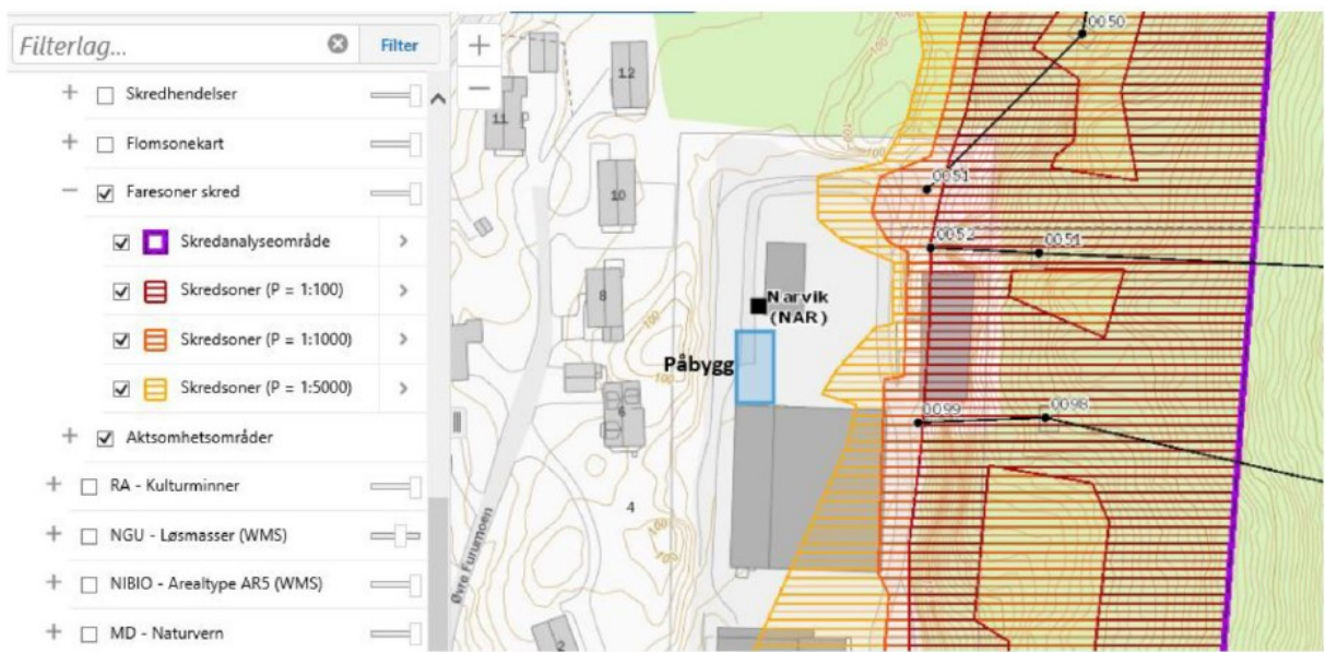
Figur 2: Tiltaksområdet ligger innenfor faresone skred i bratt terreng. Narvik transformatorstasjon er vist lysegrå firkant, og påbygget lyseblå firkant. Kilde: NVE Atlas/Statnetts kommentarer til høringsuttalelse.
