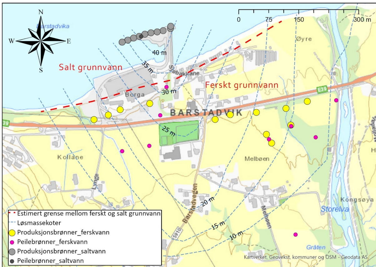
Figur 11. Estimert tykkelse av sand og grus målt fra terrengoverflaten.
