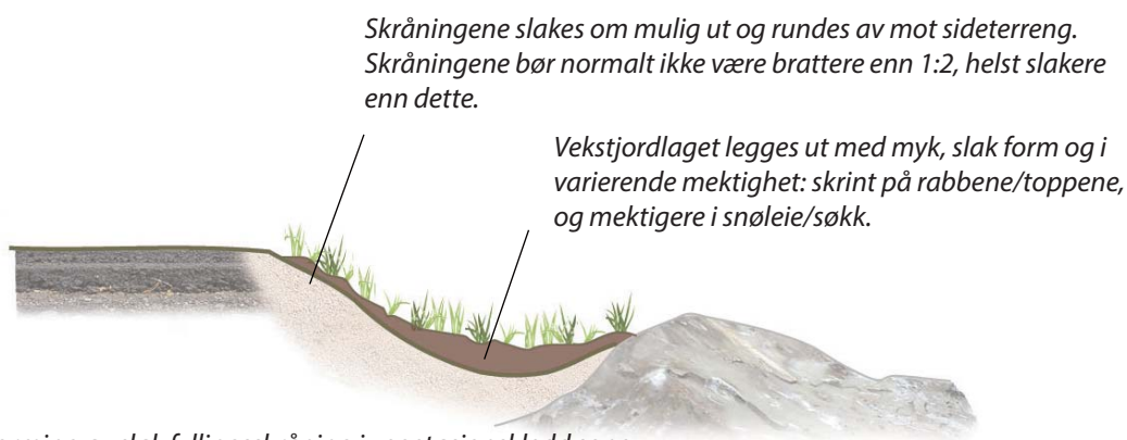
Utforming av slak fyllingsskråning i vegetasjonskledd sone
