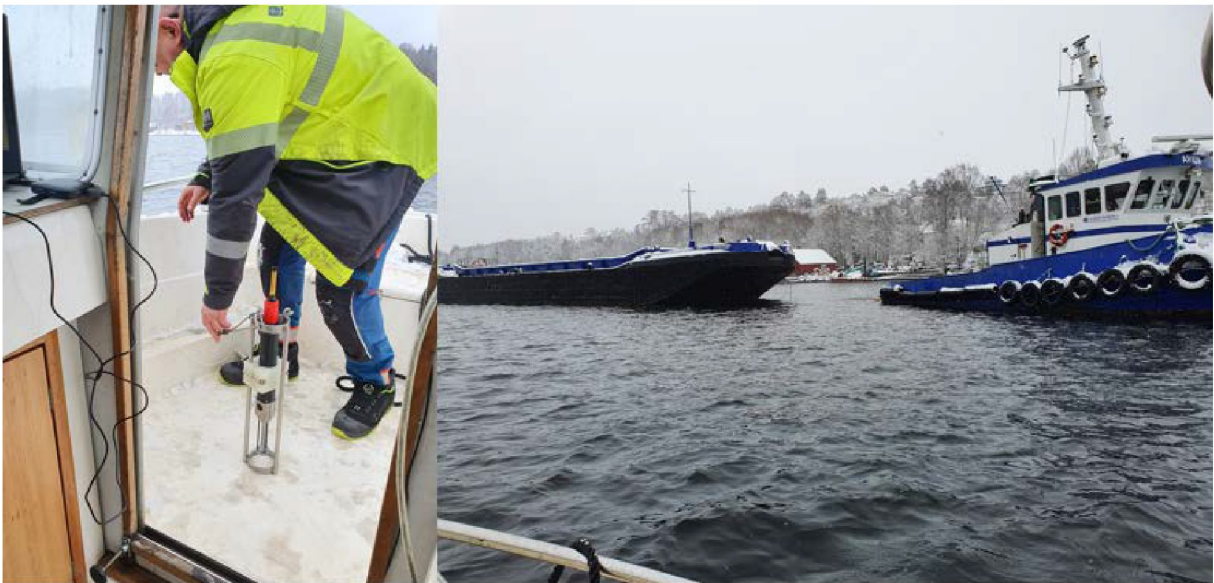
Figur 4: Kontroll av temperaturprofil i elva før skanningen og lekter med taubåt (bildene tatt fra skanningsbåten)
