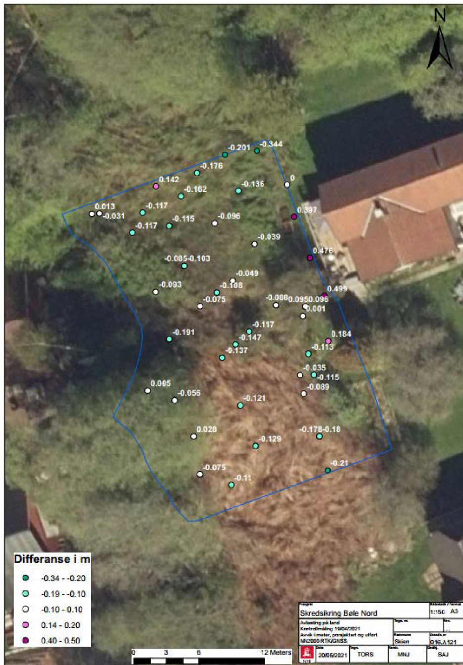
Figur 11: Fysisk stikkprøvekontroll av ferdig avlasting, målt 19.04.2021 sammenlignet med produksjonsgrunnlag. Blå linjer symboliserer prosjektet utstrekning av avlastningsområdet.
