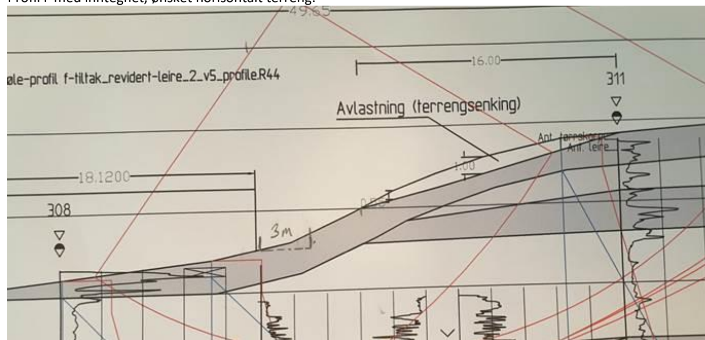
Profil G2 med utkast til avlastning, tilsvarende profil F, for (om mulig) å oppnå tilstrekkelig %-vis forbedring (1.32) også for profil G2
