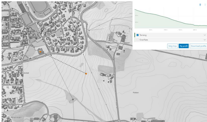
Figur 13 Skråning ned mot masta fra sør øst, jevn helning 1:18. Grunnundersøkelse viser friksjonsmasser i høyereliggende terreng.
