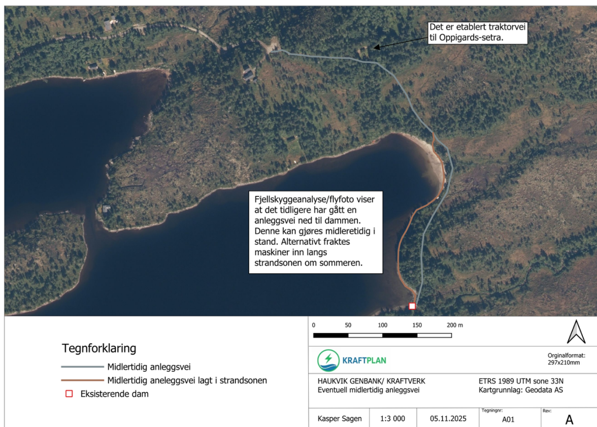
Figur 13: Veinett ved Oppsalvatnet
