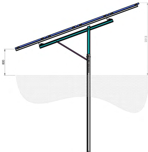
Figur 8. Eksempel på struktur, tverrsnitt. Kilde: ZIM 1-V Zimmermann PV-Stahlbau. https://www.pv-stahlbau.de/en/fix-tilt-systems/zim-1-v/
