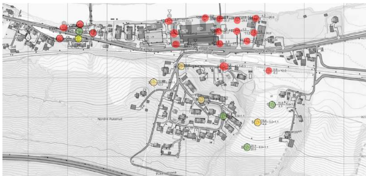
Figur 9: Oversikt over borer og funn av sprøbruddmateriale fra geoteknisk rapport utarbeidet av Grunnteknikk AS (2) og Statens Vegvesen (6). Rød = bekreftet sprøbruddmateriale, Gul = ikke avklart hvorvidt det er sprøbrudd, Grønn = tolket/bekreftet ikke sprøbruddmateriale.
