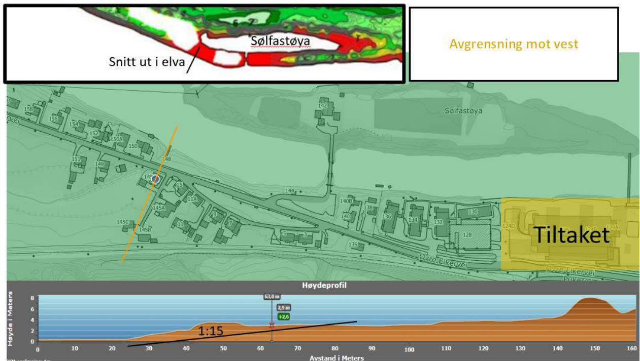
Figur 13: Snitt for avgrensning mot vest. Hentet fra hoydedata.no i mars 2022. Øverst er det bilde fra dybdekartlegging i elva og markert hvor snittet går ut i elva. Dybdekartet viser en dybde på maks 1 m.
