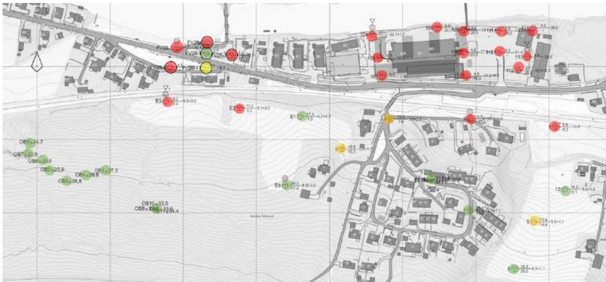
Figur 11: Utklipp fra situasjonsplan over området. Posisjoner for grunnundersøkelser er markert med rød, gul og grønn. Rød=indikerer sprøbrudd, gul=kan ikke avkrefte sprøbrudd, grønn=sprøbruddmateriale avkreftet.
