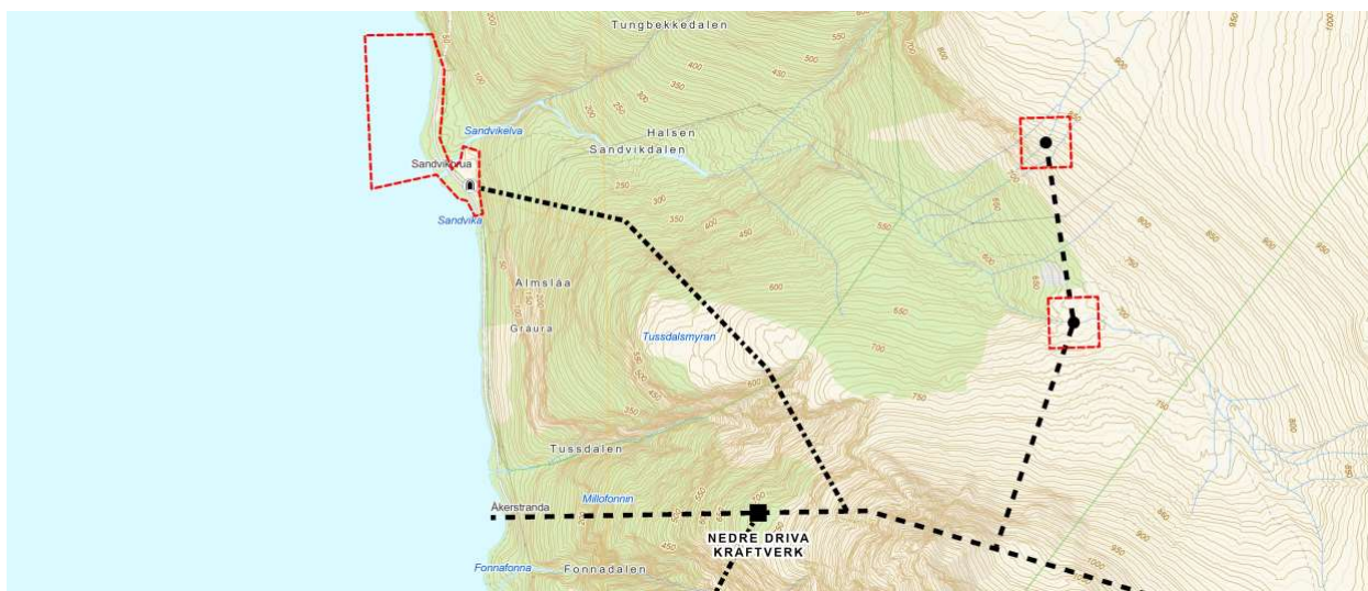
Figur 2-15: Sandvikelva I & II, oversiktstegning bekkeinntak.
