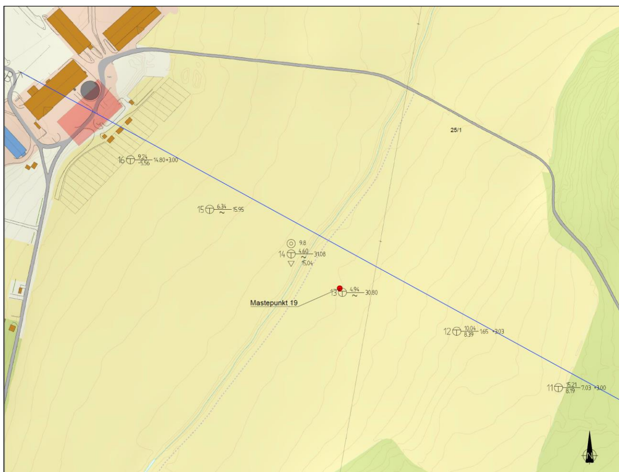
Figur 6.4 Oversikt plassering mastepunkt 19 med utførte grunnundersøkelser
