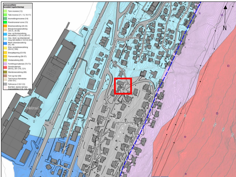
Figur 3: Ngus Løsmassekart [2] som viser fyllmasse på tomta. Maringrense er markert med blå stiplet linje.
