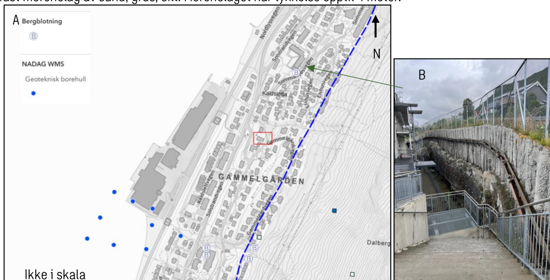
Figur 4: A: Oversikt over registreringer i felt av bergblotninger og grunnundersøkelser i området. Planområdet er merket med rødt rektangel. B: Spunt over bergskjæring i leilighetsbygget Solsia park.
