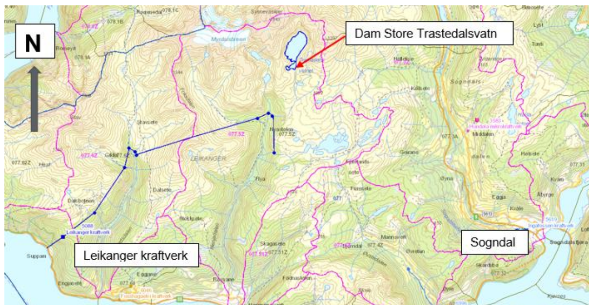
Figur 2 Plassering av Dam Store Trastedalsvatn i forhold til inntak og tunnelar i Leikanger kraftverk.
