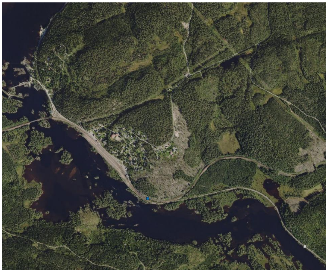
Figur 3-5 Kart som viser skredhendelser. Blå prikk er isnedfall. Hvit prikk helt til høyre i bildet er steinsprang. Kilde: NVE (2).
