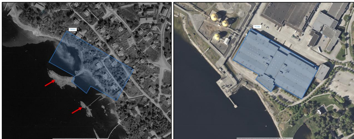
Figur 2.2 Flyfoto fra 1965 til venstre og 2024 til høyre [4]. Fotavtrykket til eksisterende bygg på Fjordgata 48 er omtrentlig vist med blå skravur. Røde piler viser berg i dagen.
