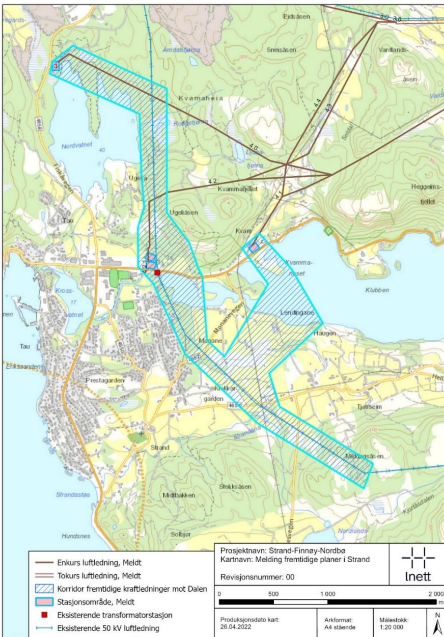
Figur 17 Fremtidig kraftledning fra ny Tau transformatorstasjon mot Fjelde/Dalen
