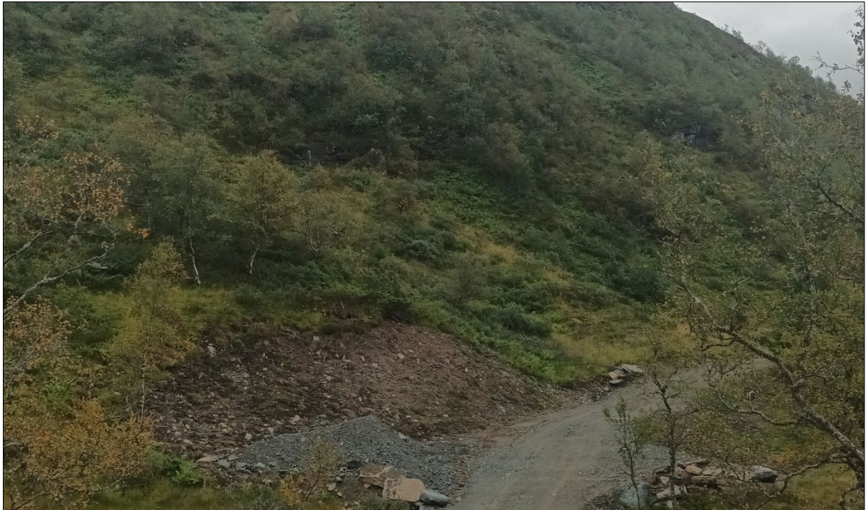
Figur 10: Biletet viser eksponerte lausmassar i nord for kartlagt område. Lausmassane det er tolka at lausmassane hovudsakleg består av morenemateriale og ein del forvittringsmateriale, då det er mykje kanta stein og blokker i lausmassane. Lausmassedekket er vurdert å vere om lag 2 meter tjukt i kartlagt område og slake parti i påverknadsområdet. Infopunkt 1.
