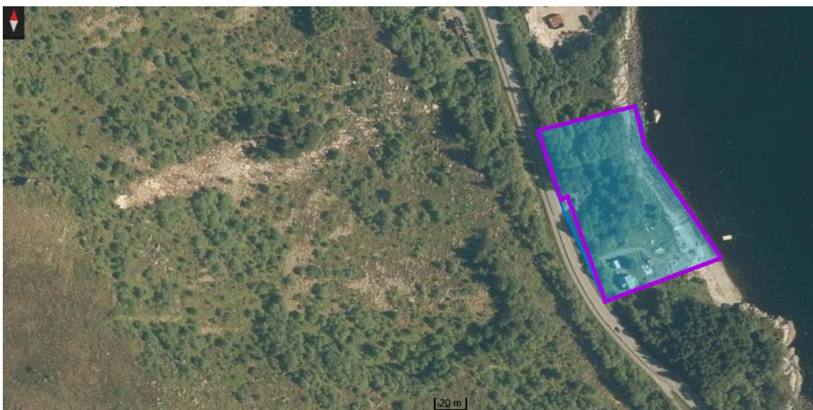
Figur 28 Ortofoto viser ingen spor etter jordskred, men i steinskredet som utløste i 2018 ble det tynnehumuslaget revet med i deler av skredet.
