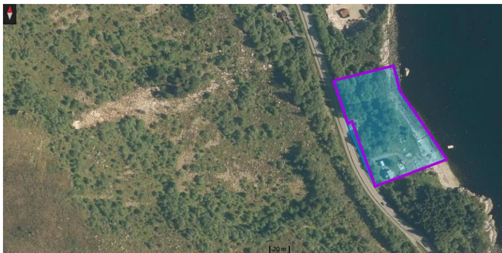
Figur 5 Ortofoto som viser det vurderte arealet på nedsiden av Brandalsvegen og influensarealet på oppsiden av veien. Steinskredet fra 2018 vises tydelig. Det samme gjør dannelsen av ur.
