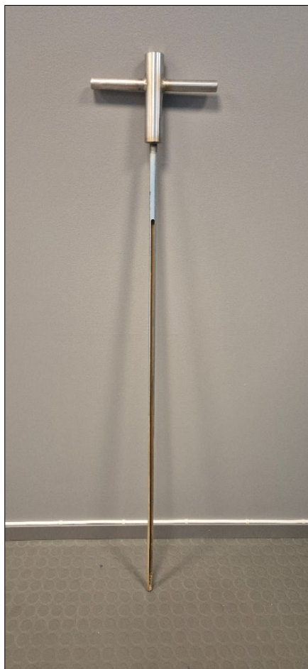
Figur 18: Boniteringsstangen som ble brukt under feltarbeidet. Total høyde er 130 cm. Stangen er hul for å kunne undersøke hvilke løsmasser det boniteres gjennom. Foto: SGC.
