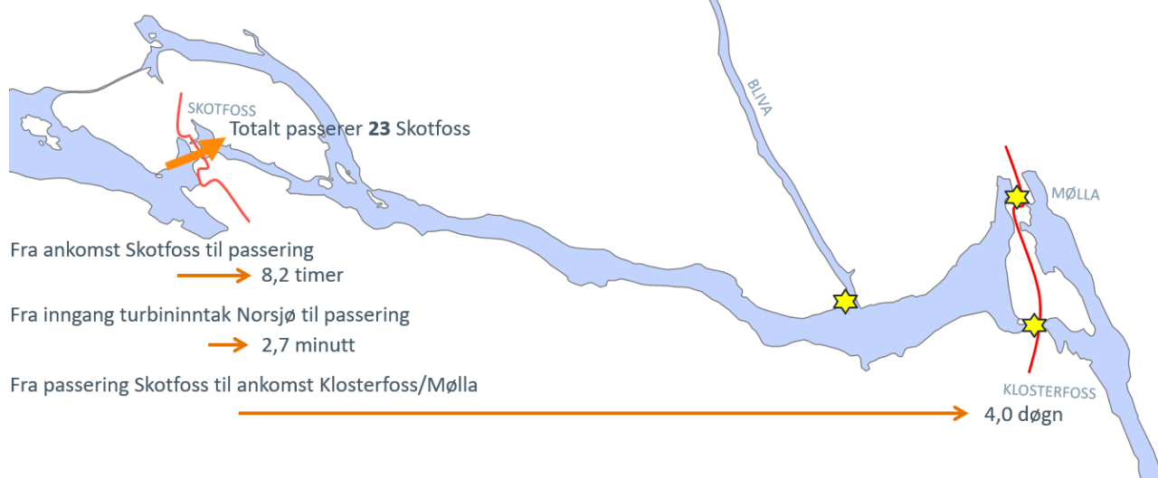
Figur 31. Tidsbruken til 23 smolt som passerte Skotfoss i 2022 viste at smolt passerte ganske raskt etter at de først kom fram til dam, overløp og turbininntak. Median tid til passering var 8,2 timer, og de som gikk inn i en av turbinene ble raskt dratt gjennom på 2,7 minutter. Etter passering brukte smolten imidlertid ofte flere dager på å vandre ned til Skiensfallene, median 4 døgn.
