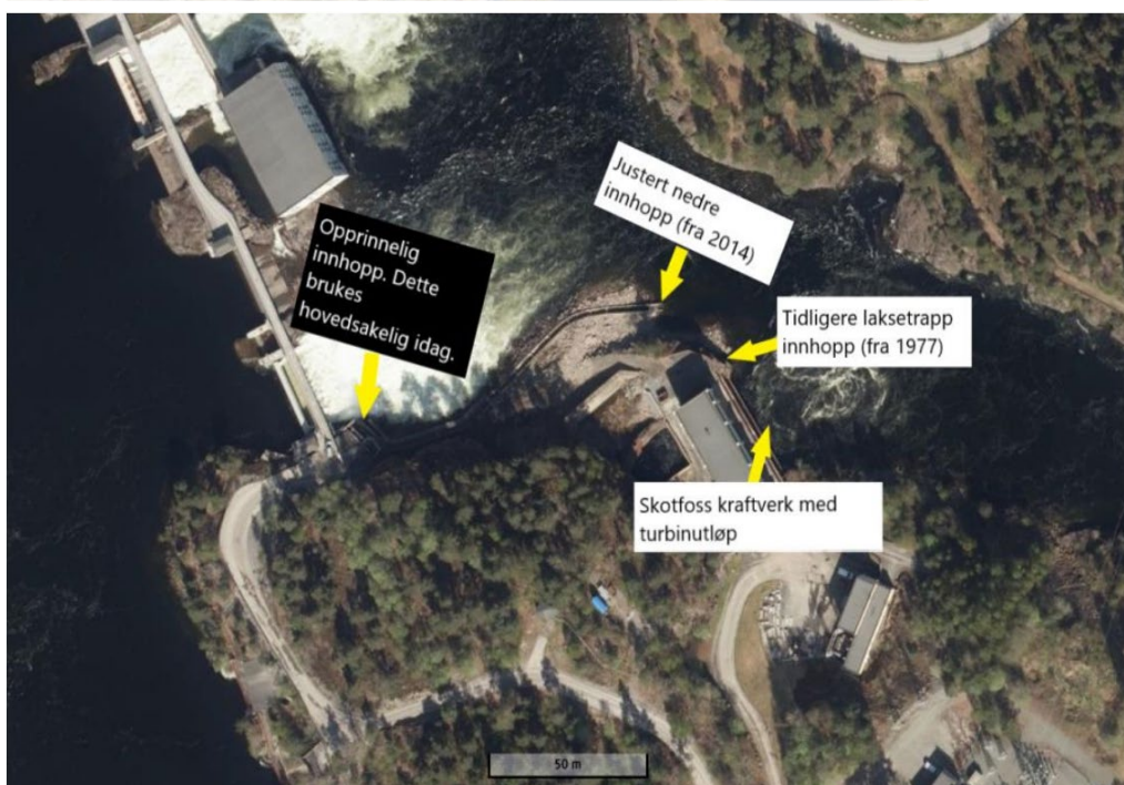
Figur 7. Øverst: Skiensfallene med Klosterfoss og Eidet kraftverk og fisketrapper og omløpsrør i Klosterfoss og fisketrapp i Møllefoss hvor fisk kan vandre ned til eller opp fra brakkvann i Bryggevatnet/Porsgrunnselva. Nederst: Skotfoss kraftverk og fisketrapp. De to nedre innløpene ved utløp fra Skotfoss kraftverk er ikke i bruk i dag.
