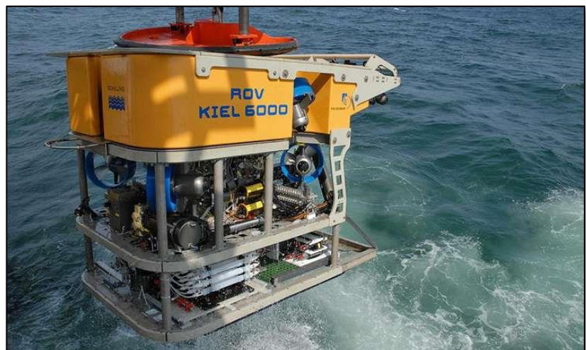
Figur 6-8. ROV/undervannsdrone til videoinspeksjon av havbunnen. Foto: eskp.de / Earth System Knowledge Platform – CC BY4.0
